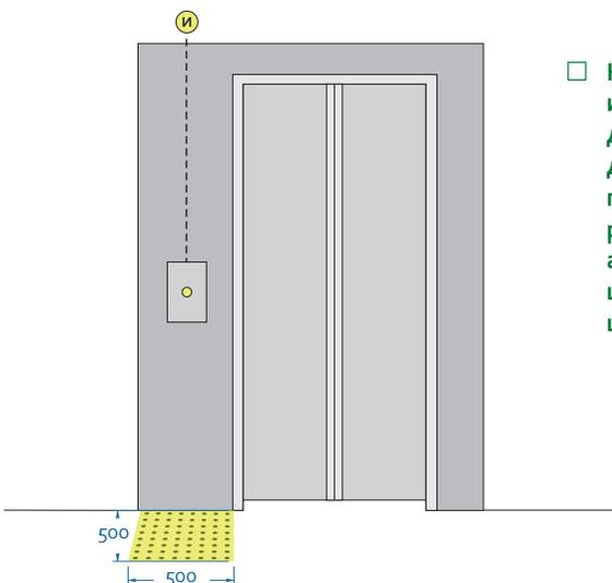
Кнопки вызова и управления движения лифта должны быть промаркированы рельефными арабскими цифрами и шрифтом Брайля.
