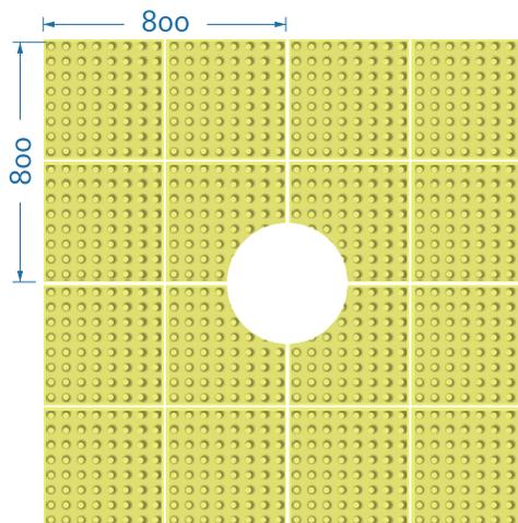
\* Место пересечения или изменения направления пути движения, обозначенное тактильными предупреждающими указателями (дискретными элементами) на пешеходной поверхности.
